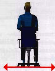
Mindestbreite der Bewegungsfläche im Sitzen und Stehen \geq 1,5 m
