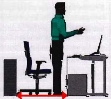
Mindesttiefe der Bewegungsfläche im Sitzen und Stehen \geq 1 m
