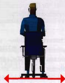
Mindestbreite der Bewegungsfläche im Sitzen und Stehen ≥ 1,5 m
